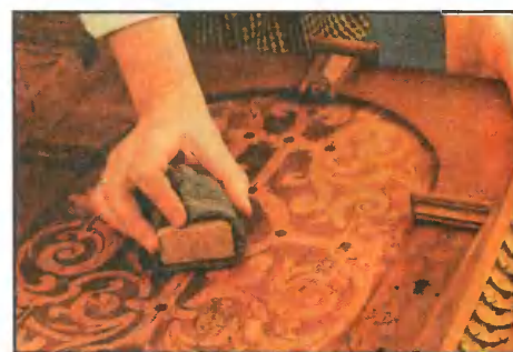
Фасадная поверхность шкафа в стиле ренессанс: промежуточное шлифование после нанесения грунта на основе льняной олифы и уайтспирита.
