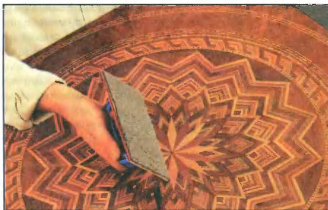
Поперечная доска спинки стула, выполненного из вишни в стиле бидермейер. Промежуточное шлифование при отделке шеллачной политуры.
